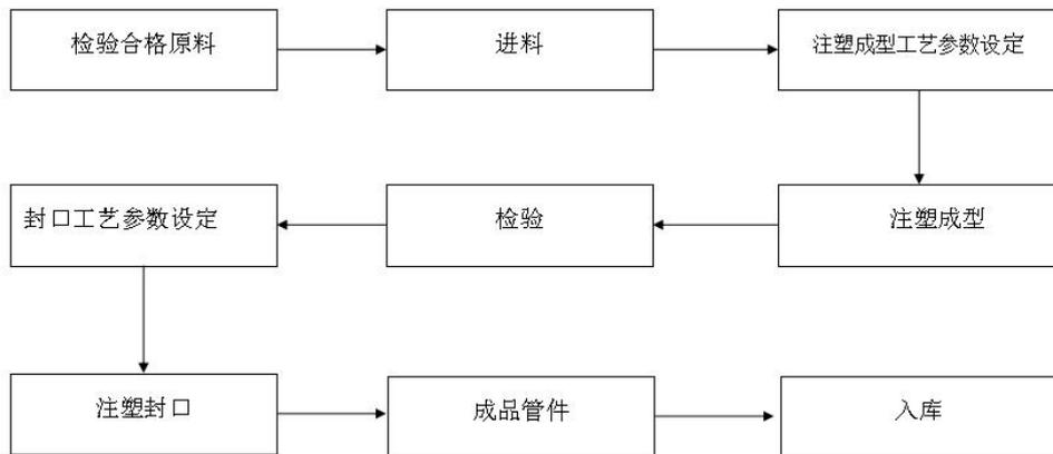
所有管件均带金属骨架，在注塑管件的结构和生产工艺上，应用了多项公司自主开发的专利技术，实现了钢骨架无金属定位钉或无定位钉式生产，管件表面无金属外露、钢塑复合结构稳定、表面 PE 层熔合质量好。
