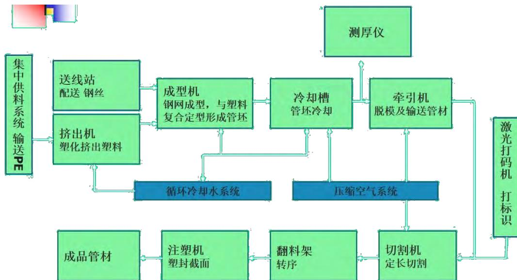
DN700-800 钢骨架聚乙烯塑料复合管是应用了公司专利技术(其复合管壁内钢骨架采用三层钢丝结构：一层经线一层右旋缠绕纬线和
